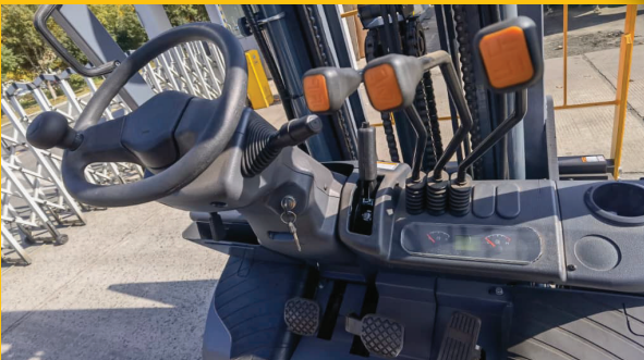
TÜM AKSAM ÖN GÖĞÜS KOMPLE GÜÇLENDİRİLMİŞ BAKALİT SİSTEMİ FULL GÖSTERGE KOLAY KULLANIM FULL AÇIK ASANSÖR GÖRÜŞÜ İTALYAN CASCADE MARKA SIDE SHIFTER. POTANSİYOMETRELİ GAZ PEDALI.
